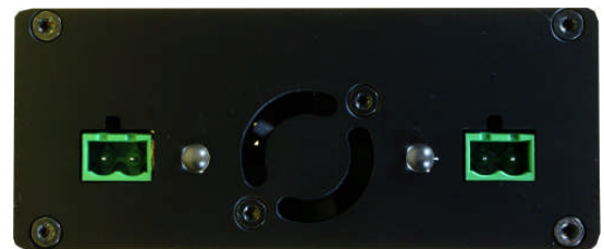
Anschlüsse Ausgangsseite des µCon-Boosters v.l.n.r.: Anschluss Gleis B, Info-LED Gleis B Anschluss Gleis A, Info-LED Gleis A
