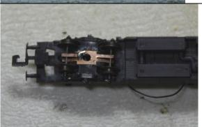
Das angelötete Kabel wird durch die Bohrung und somit nach innen geführt. Der Achsschleifer selbst wurde mit Sekundenkleber (Pattex Ultra Gel) ins Drehgestell eingeklebt.
