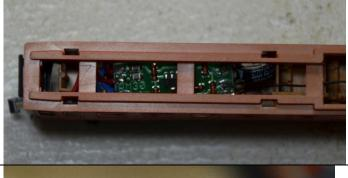
Nachdem im nächsten Schritt die LEDs an den entsprechenden Lötpads angelötet wurden – WIEDER POLUNG BEACHTEN !!, kann man mit dem Zusammenbau beginnen. Hier passt alles ohne weiteres Entfernen von Plastik rein, in anderen Umbauten mussten auch schon Stege im oberen Bereich entfernt werden.
