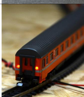
Belohnt wird man mit einer schönen roten LED-Schlussbeleuchtung, die bei Fahrten über die Anlage konstant ist und nicht flackert – wenn der Kondensator aufgeladen ist. "Zaubern" kann man, wenn man den Wagen von den Gleisen nimmt und die LEDs immer noch nachleuchten (bis der GoldCap-Kondensator entladen ist….)
