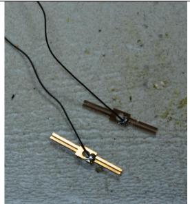
Zuerst werden an die Stromabnehmer Kabel angelötet. Eines kann kürzer sein, das andere sollte etwa der Wagenlänge entsprechen. Hier wurde Decoderlitze verwendet, da diese relativ dünn und auch flexibel ist. Alternativ kann auch Kupferlackdraht verwendet werden.
