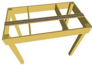
Das Trassenbrett dient zur Aufnahme des Gleises und sollte mindestens 80 mm breit sein. Im Bereich der Kopfstücke ist das Trassenbrett diesen entsprechend anzupassen. Da die Planungshöhe durch die Kopfstücke bestimmt wird, muss das Trassenbrett zwischen diesen eingepasst werden.
