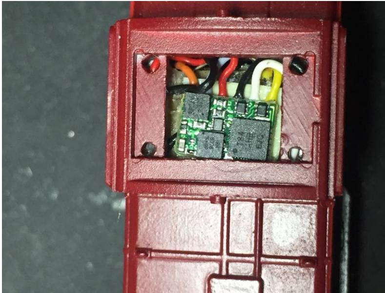
(Bild 7: Position Decoder mit abgenommenem Dach)
