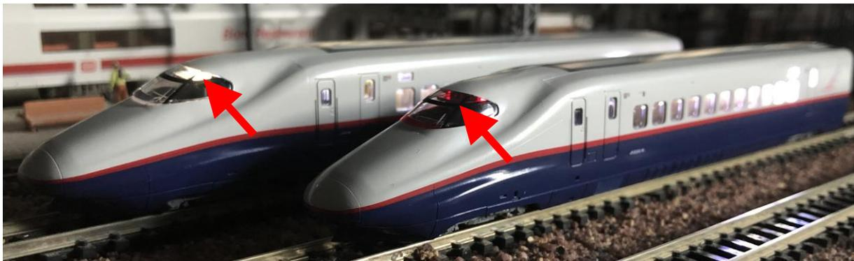
(Bild 8: Lichtwechsel invers an den Steuerwagen)
