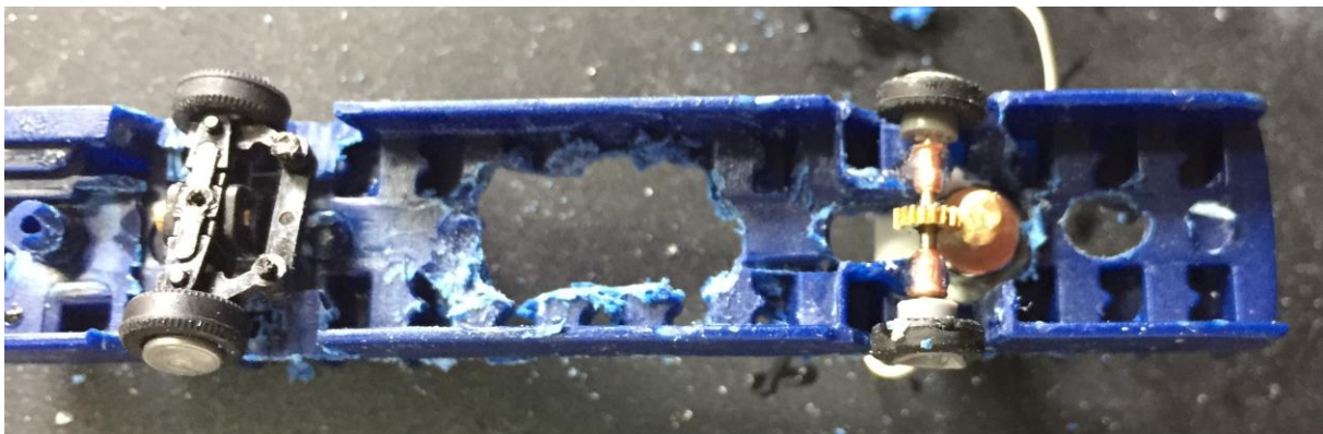
Bild 5a: Öffnung für Servo
