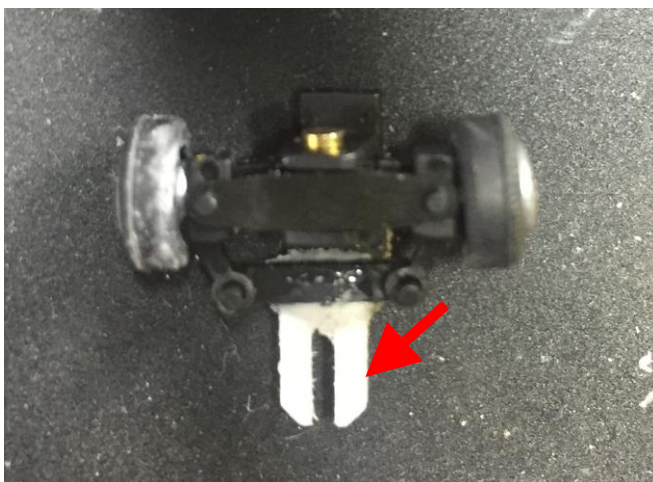
Bild 2: vorbereitete Lenkachse mit Polysterol-Verlängerung – Ansicht von unten
