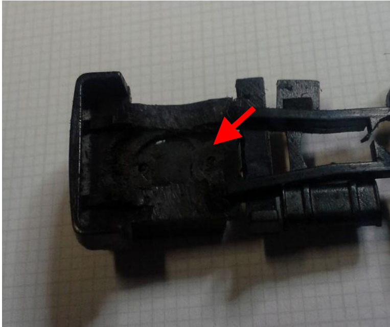
Bild 2 – abgefrästes Chassis für Lenkachse
