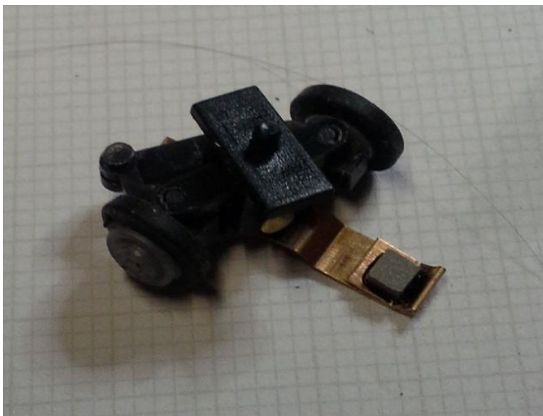
Bild 3 – Lenkachse mit Lenkstange
