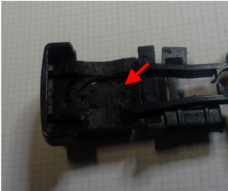
Bild 2 – abgefrästes Chassis für Lenkachse
